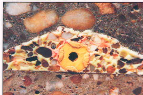
7 Efekt uzyskany po dwukrotnej iniekcji węża FUKO w przerwie roboczej żywicą DUROSEAL INIEKT:
